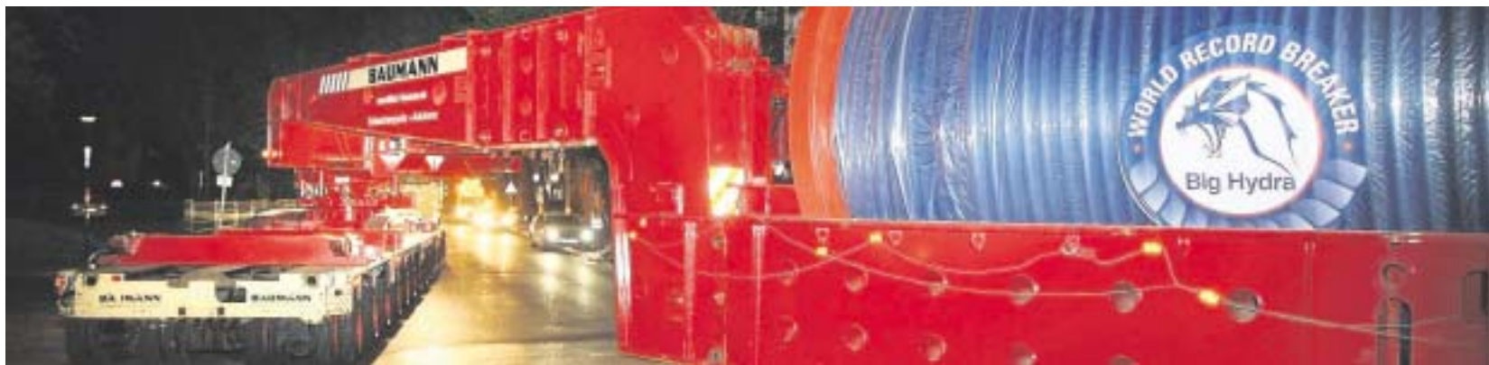
28 Achsen trugen eine Gesamtlast von 670 Tonnen. Viel mehr, sagen Experten, ist nicht mehr möglich.
